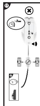
⑪ Zůstane-li červená LED dioda svítit, přesuňte detektor Stud Sensor 100 na jiné místo a pokusete se o kalibraci znova. Uvolnění aktivačního tlačítka způsobí vypnutí snímače.
