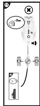
**Uwaga:** podczas kalibracji wykrywacza Stud Sensor 100 nie wolno umieszczać bezpośrednio nad profilem, gęstym materiałem, takim jak metal, lub nad mokrym lub świeżo pomalowanym miejscem, ponieważ uniemożliwi to poprawną kalibrację.
