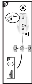
11 Om den röda lysdioden lyser stadigt, flytta Stud Sensor 100 till en annan plats och försök igen. När aktiveringsknappen släpps, stängs sensorn av.
